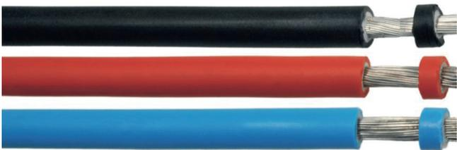
Flexible Einzelader für Photovoltaik- und Solaranlagen mit vernetzter Polymerisolierung und halogenfreiem Außenmantel. Die zu erwartende Nutzungsdauer unter normalen Bedingungen beträgt mindestens 25 Jahre. Die Leitung wird zur Verkabelung von Solarmodulen untereinander eingesetzt und ist für die feste Verlegung im Außen- und Innenbereich geeignet, auch für direkte Erdverlegung (die spezifischen Verlegevorgaben sind dabei zu berücksichtigen).
