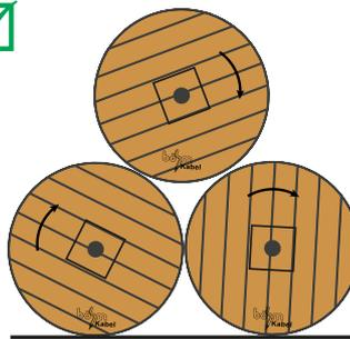
Ein Stapeln der Kabeltrommeln darf nur mit Verschalung realisiert werden. Die untere Lage ist über die gesamte Trommelbreite zu sichern.
